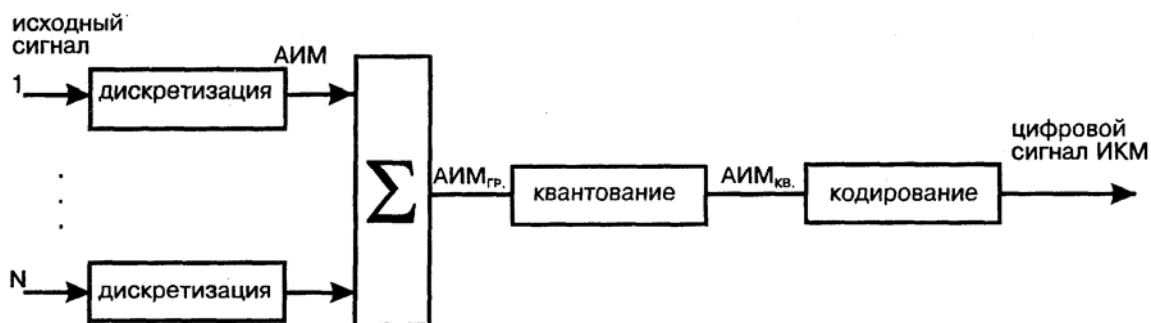
Рис. 4.3. Принцип формирования цифрового группового сигнала
