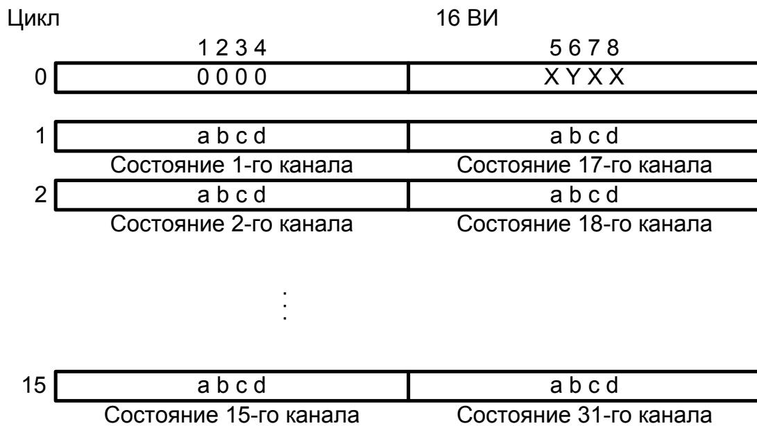
Рис. 4.6. Организация сигнальных каналов в ЦСП ИКМ-30
