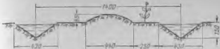
Рис. 39. Профиль бороздково-террасной поверхности (размеры в миллиметрах).
