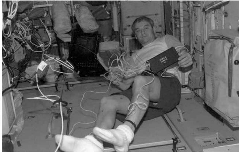
Рис. 4.10. Биоимпедансный анализатор “Спрут-К” в момент обследования космонавта на Международной космической станции
