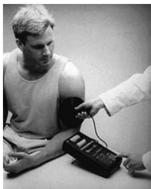
Рис. 4.18. Инфракрасный жироанализатор Futrex-5000XL. Момент измерений
