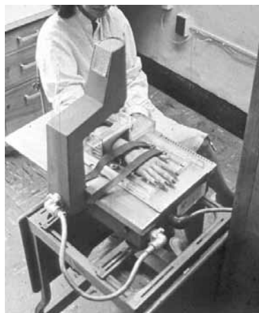
Рис. 4.22. Одна из первых моделей монофотонного остеоденситометра (общеклиническая больница штата Массачусетс, г. Бостон, США, начало 1970-х)
