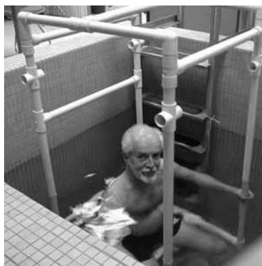
Рис. 3.1. Стационарная установка для гидростатического взвешивания. Момент начала измерений
