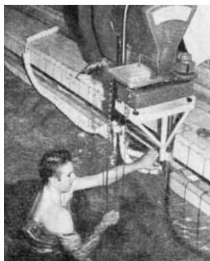
Рис. 3.2. Портативное устройство для гидростатического взвешивания (Жданова, 1962)
