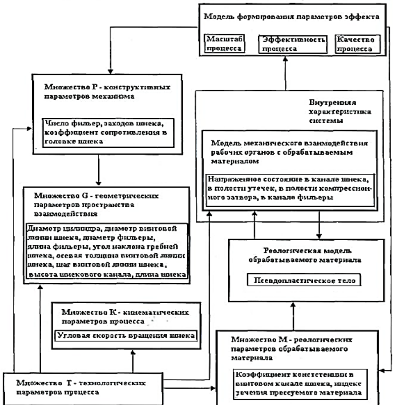
Рисунок 36 - Структура математической модели одношнекового экструдера
