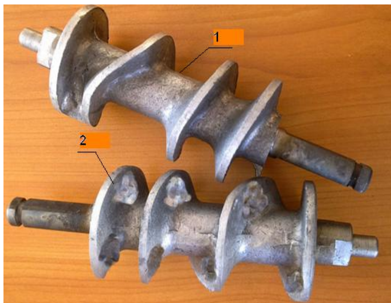
1-конструкция шнека с базовыми параметрами, 2 – конструкция модернизированного шнека
