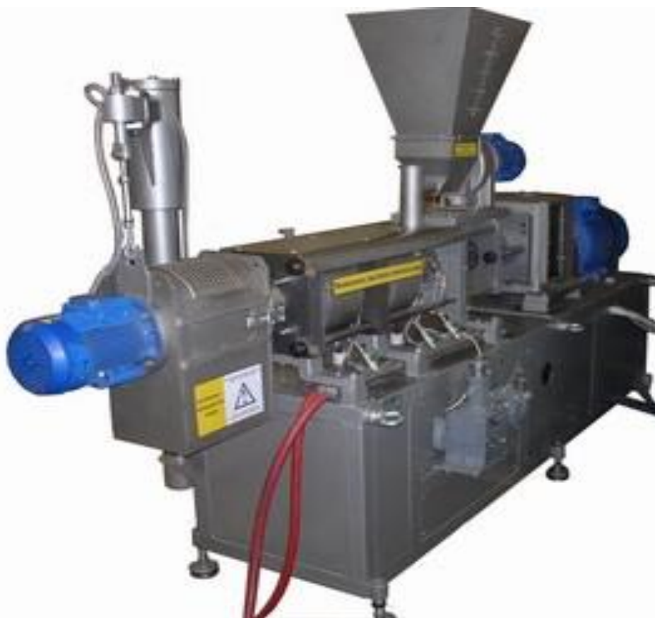
Рисунок 71 - Двухшнековаяэкструзионная установка ВЭС-ЭУ-2
