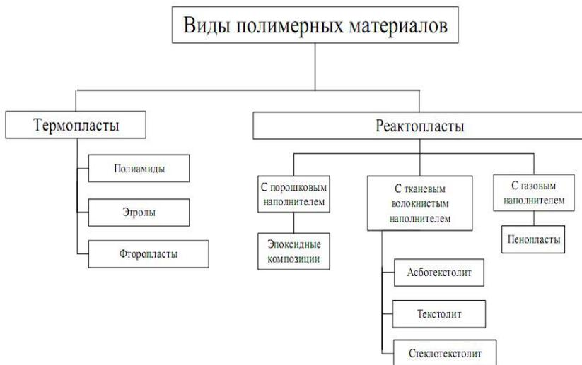
Рис. 12. Пластмассы, применяемые при производстве и ремонте Автомобилей
