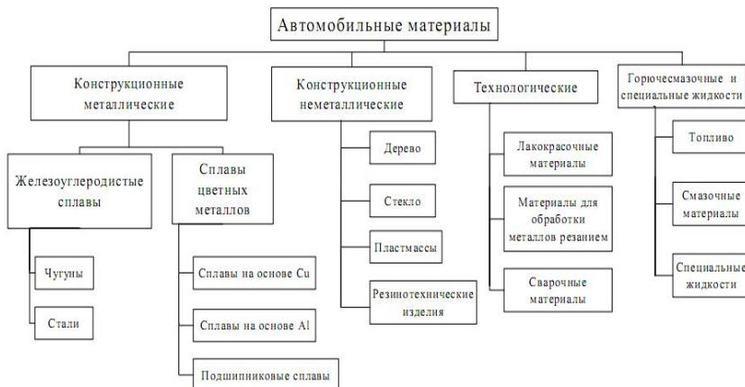
Рис. 1. Классификационная схема автомобильных материалов
