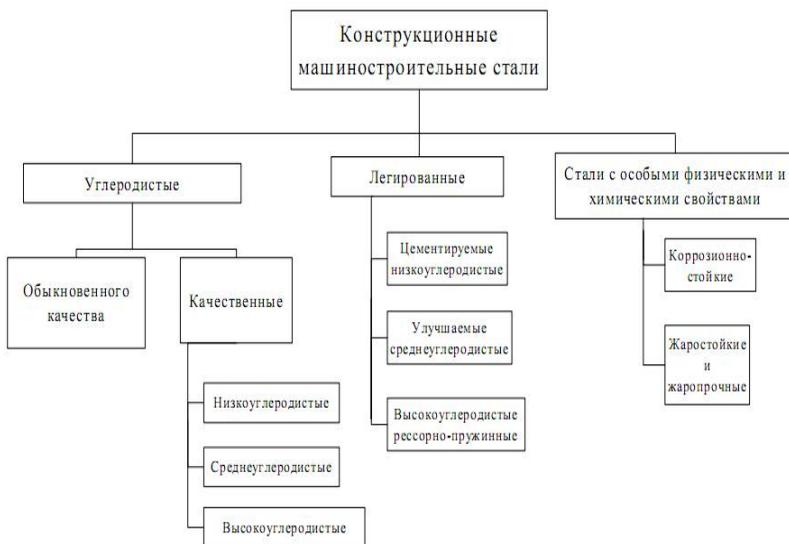
Рис. 9. Классификация конструкционных машиностроительных сталей
