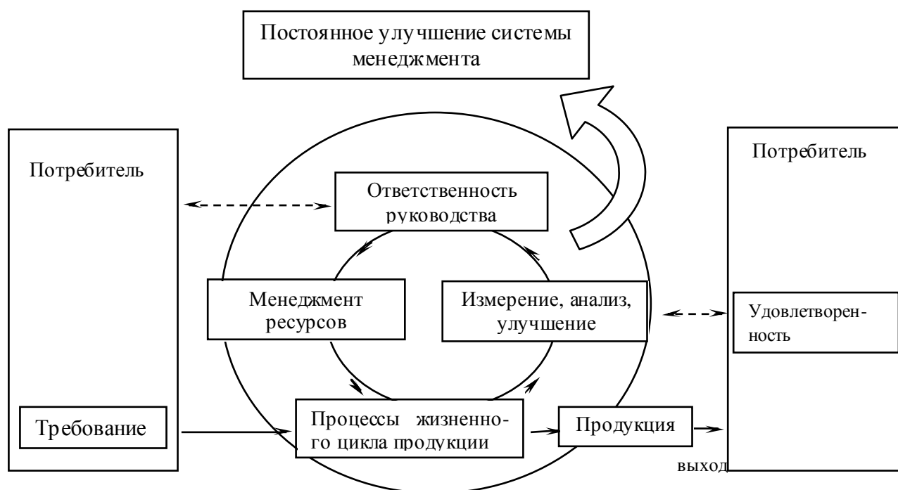
Рис. 1.3. Модель системы менеджмента качества, основанная на процессном подходе (ИСО 9000:2000)
