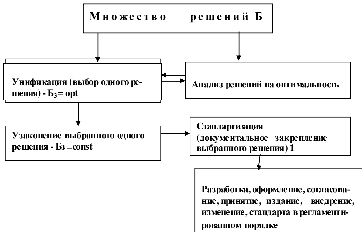
Рис.2.1. Последовательность решения типовой задачи стандартизации
