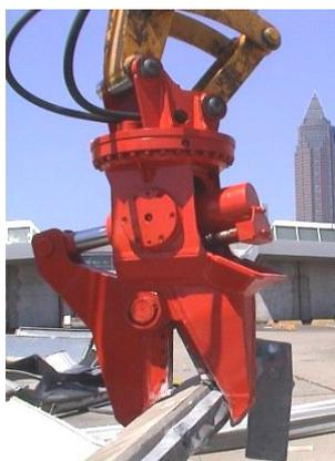
Рисунок 1.18. Гидрорезицы Ramtec–Robi
