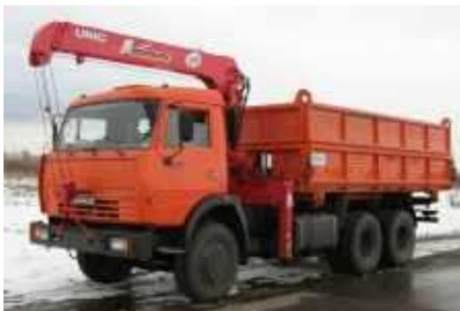
Рисунок 1.4. Автомобиль самосвал КАМАЗ 65117 (6x4)
