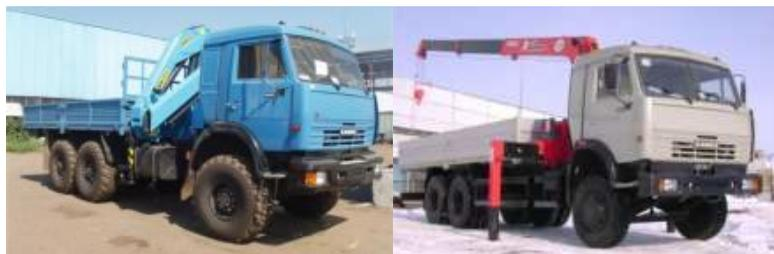
Рисунок 1.5. Бортовой автомобиль Камаз с кран-манипулятором
