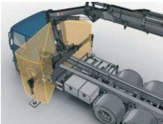
Рисунок 1.15. Система безопасности OPS компании Hiab
