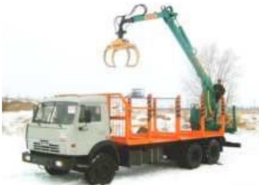
Рисунок 1.1. Сортиментовоз с краном-манипулятором на шасси автомобилей КАМАЗ 53229 (6x4), 53228 (6x6), 43118 (6x6)
