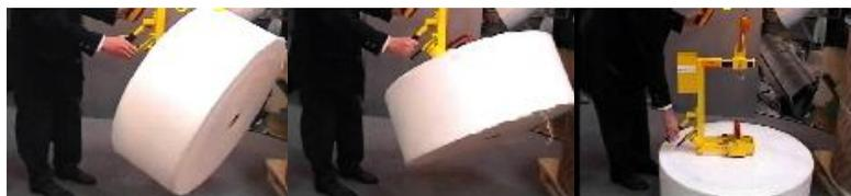
4) Поворачиваем      5) Поворачиваем      6) Опускаем и убираем зубья
