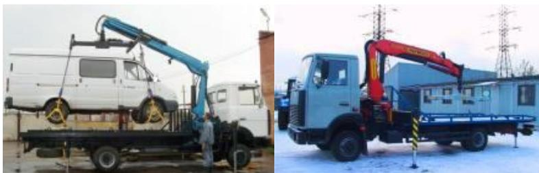
Рисунок 1.3. Эвакуатор на шасси МАЗ
