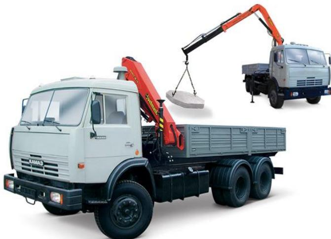
Рисунок 1.6. Кран-манипулятор КМУ-90 на шасси автомобиля КАМАЗ 50205 с расположением за кабиной и поперечной схемой складывания
