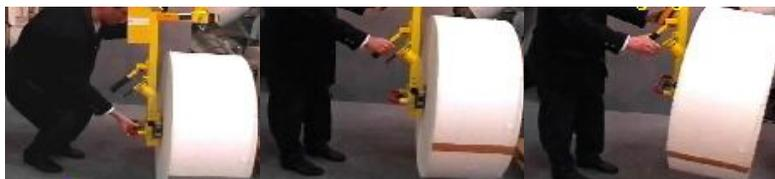
1) Вводим штырь в      2) Выпускаем зубья      3) Поднимаем рулон
