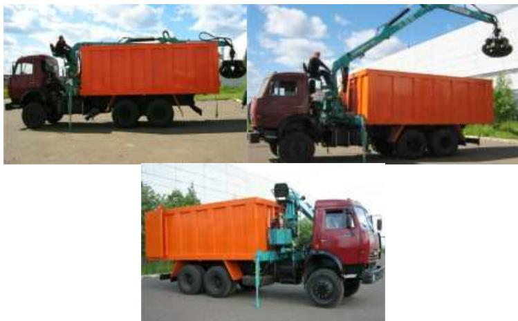
Рисунок 1.2. Ломовоз (металловоз) с крано - манипуляторной установкой на шасси автомобиля КАМАЗ-53229-1064 (65115)
