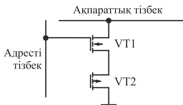
6.3-сурет. Ақпаратты электрлік жазбасы бар жад элементі
