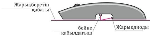
6.4-сурет. Оптикалық тінтуір әрекет ету принципі
