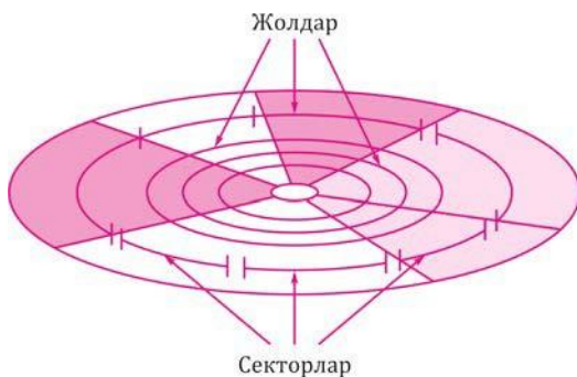
3.3-сурет. Магнит дискті форматтау кезінде жолдар мен секторларға бөлу
