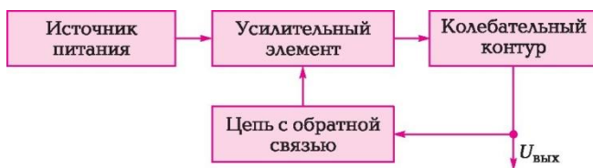
3.1-сурет. Электронды генератордың құрылымдық сызбасы
