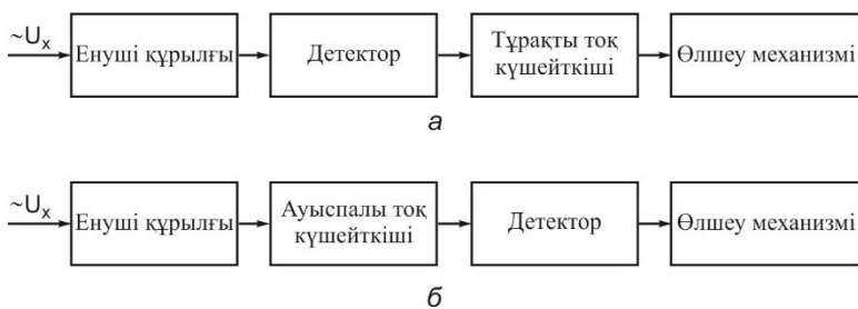
5.7-сурет. Тұрақты токтың электрондық вольтметрiнiң құрылымдық сызбасы: а — жиiлiк диапазоны бар вольтметрге арналған сызба; б — сезiмталдығы жоғары вольтметрлерге арналған сызба.
