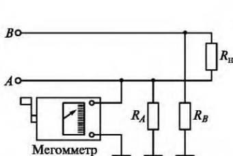
7.10-сурет. Кернеуі болмайтын, желіні оқшаулау кедергісін өлшеу кезіндегі тізбек сызбасы
