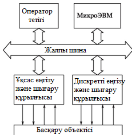
7.5-сурет. Ремиконт схемасы
