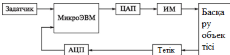
7.4-сурет. МикроЭВМ базасында басқарудың бірконтурлы жүйесінің схемасы
