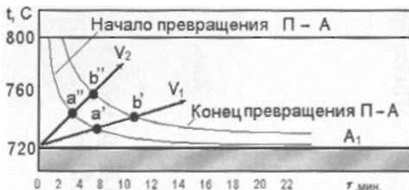
Рисунок. 47. Превращение перлита в аустенит при постоянной температуре для стали, содержащей 0.86 % C.
