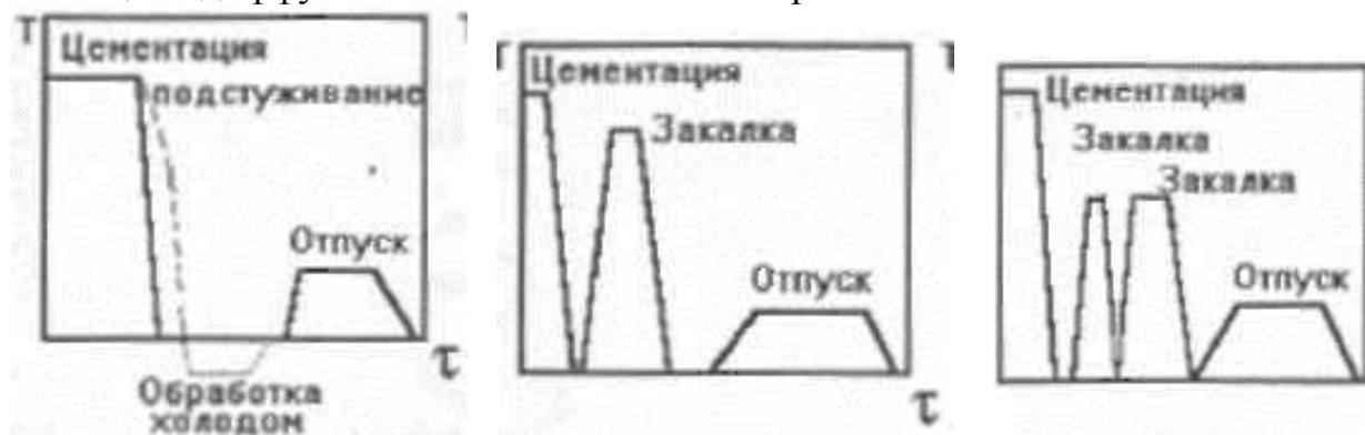
Рисунок.62. Режимы термической обработки цементированных деталей.
