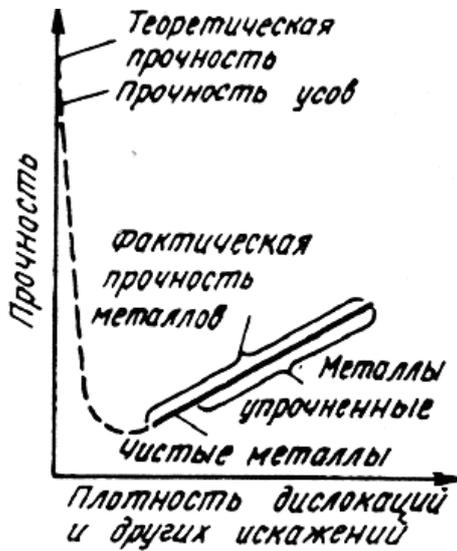
Рисунок. 8. Влияние искажений кристаллической решетки на прочность кристаллов
