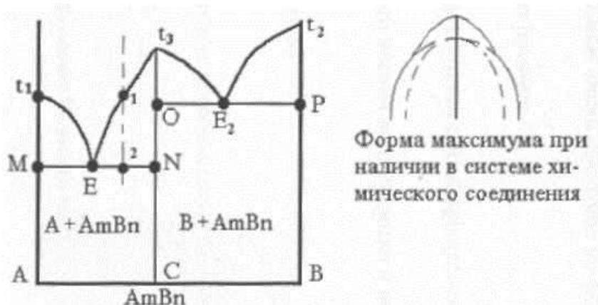
Рисунок.33. Диаграмма состояния системы, образующей устойчивое химическое соединение.
