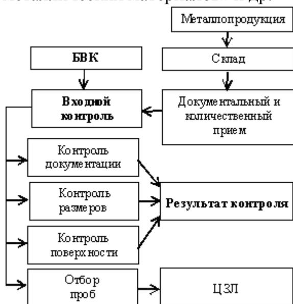
Рисунок. 11. Типовая схема организации входного контроля
