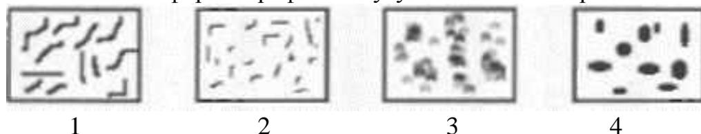
Рисунок. 42. Возможные формы графита в чугунах. 1 - пластинчатый, 2 - мелкопластинчатый (вермикулярный), 3 - хлопьевидный, 4 - шаровидный графит.
