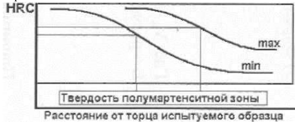
Рисунок 58. Кривая прокаливаемости стали.
