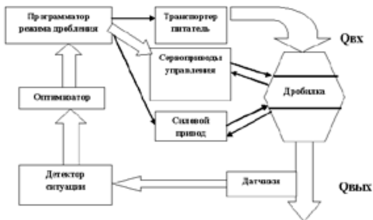
Рисунок 5 – Структура автоматизированной системы автоматического регулирования производительности на основе самонастраивающихся алгоритмов оптимизации
